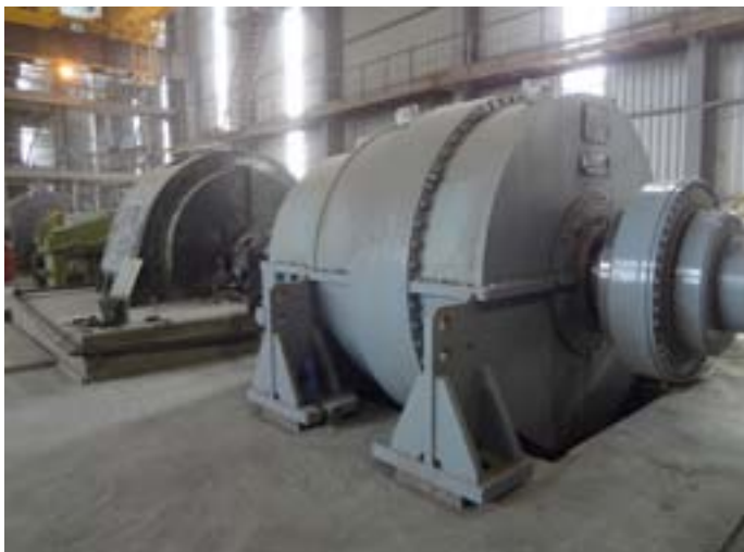
Рис. 5. Новый редуктор MAAG типа CPU-22/B
