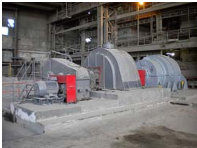
Рис. 6. Новый привод с редуктором типа CPU-22/B
