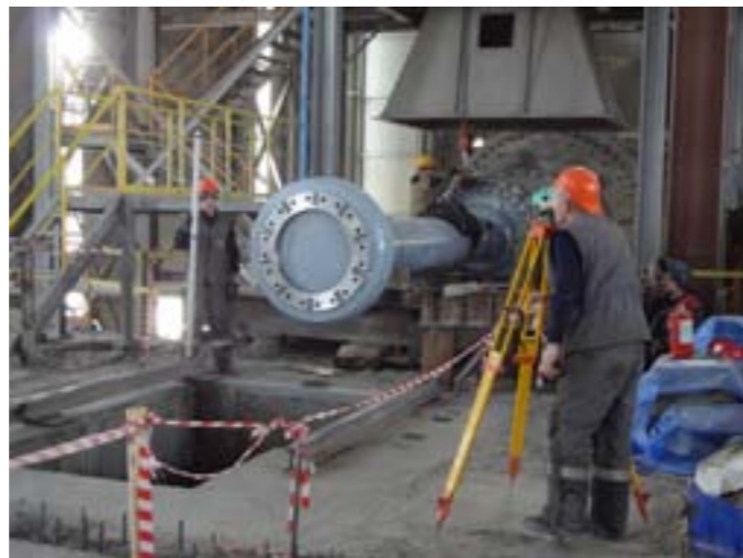
Рис. 2. Выравнивание тихоходной муфты
