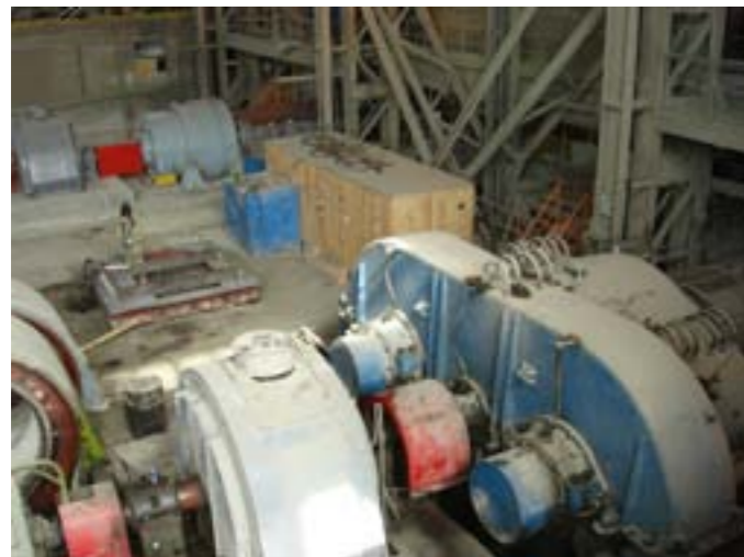
Рис. 1. Передний план: старый привод цементной мельницы, задний план: новый привод с редуктором CPU
