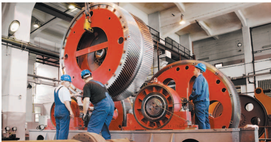
Рис. 1. Замена вращающихся частей редуктора Symetro
