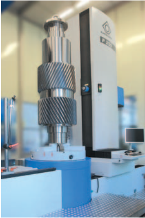
Рис. 2. Контроль качества быстроходной шестерни
