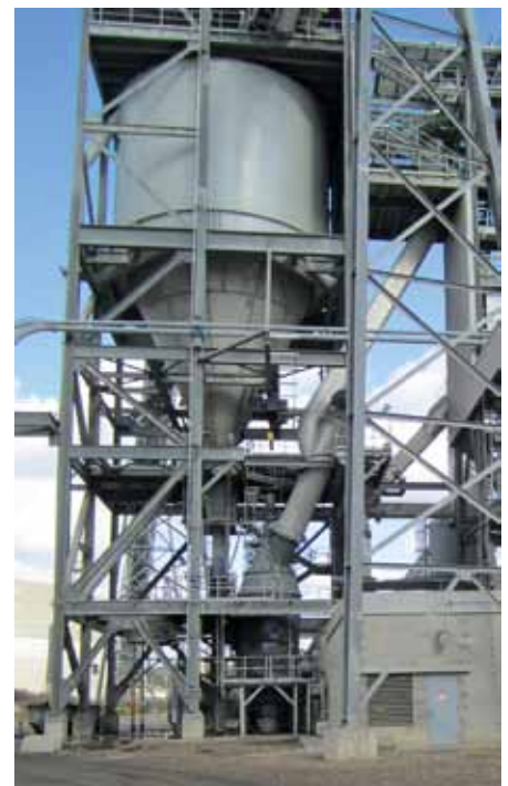
Рис. 1. Мельница FLSmidth Atox с редуктором MAAG™ для угольной мельницы
