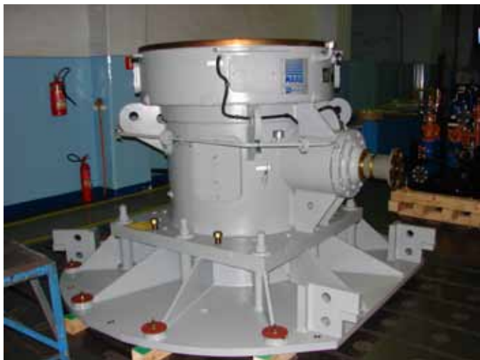
Рис. 2. Редуктор MAAG WPU 06 для угольной мельницы со специальной рамой для адаптации при замене редуктора менее компактной конструкции
