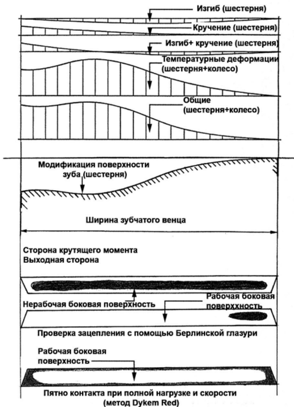
Рис. 7. Модификация поверхности зуба косозубой шестерни
