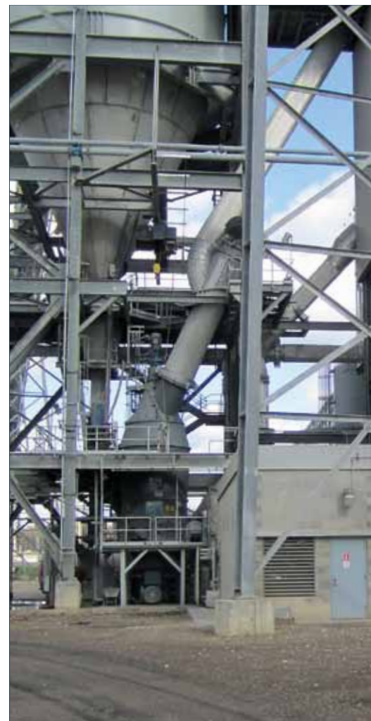
Мельница FLSmidth Atox с редуктором MAAG™ для измельчения угля
