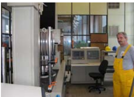
Рис. 12. Контроль зубчатых колес на контрольно-измерительной машине в специальном термостабильном помещении
